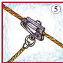
Collegamento con cordino e dispositivo scorrevole
