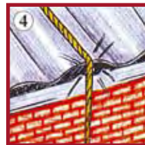
Punto con rischio taglio/rottura fune di collegamento
