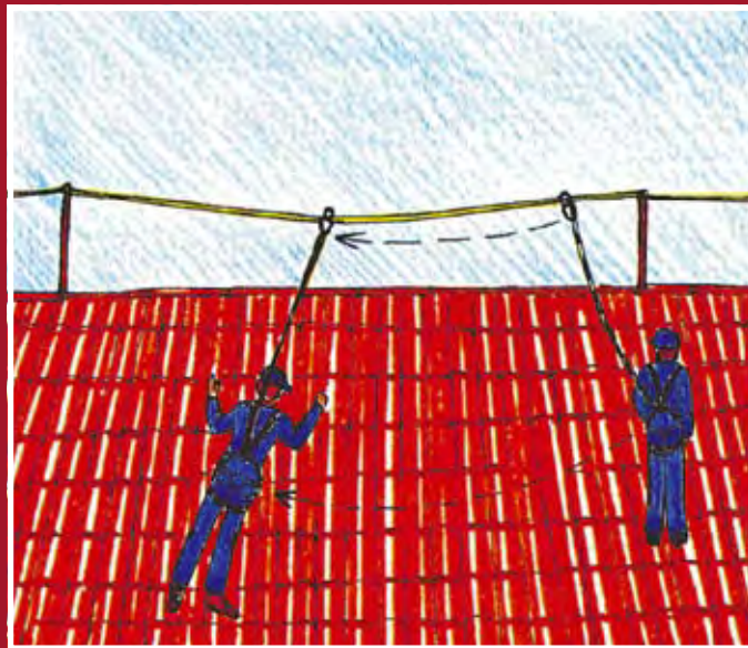
Fig. 2. Effetto pendolo: caduta dell'operatore collegato a un linea di ancoraggio
