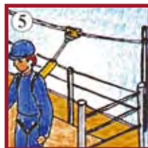
Collegamento con cordino e dispositivo scorrevole
