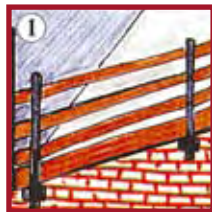
Solido ancoraggio montanti del parapetto
